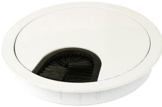
Der KABELDURCHLASS in runder Form ist aus Zinkdruckguß hergestellt. Die Öffnung zur Kabeldurchführung ist mit Staubbürsten abgedeckt. Um größere Stecker durchzuführen, kann der Innendeckel herausgenommen werden.
